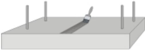
Den Kontaktkleber mit einem Pinsel gleichmäßig dünn auf den Untergrund auf voller Länge des aufzuklebenden Fugenbandes auftragen.
